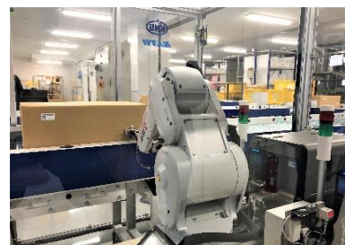
RFID ラベル自動貼付システム (スキャントロニクス® CL4NX-J_RFID/ CL4NX-J12)
